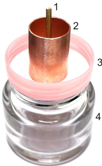
Рис. 2. Конструкция асимметричного сенсора, 1 – латунный штыревой электрод, 2 – цилиндрический медный электрод, 3 – пластиковая крышка (показана в перевернутом состоянии), стеклянный контейнер 50 мл.
