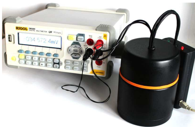
Рис. 9. Подключение сенсора к стационарному прецизионному мультиметру с VISA интерфейсом. Используется термостабилизированный контейнер от 'настоющей ЭБХ лаборатории'.
